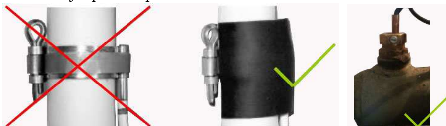
Obr. č. 8 – zapojení teplotních čidel
